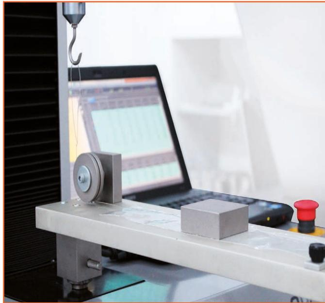
Friction test su film plastico, ISO 8295 - DIN 53375
