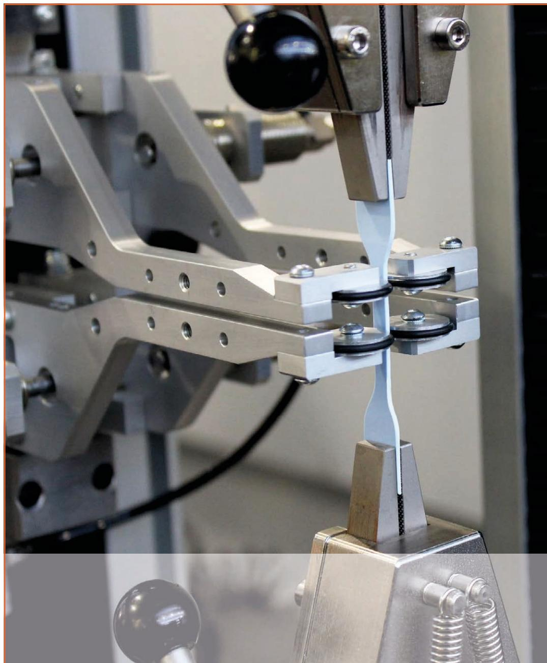
Estensimetro Plast con coltelli in gomma nitrilica ASTM D412 – ISO 37
