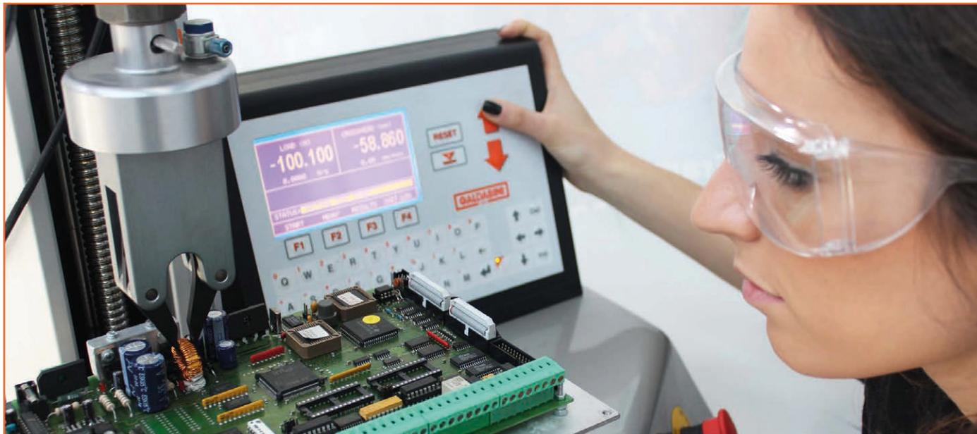
Prova di trazione su componenti elettronici
